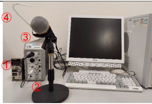
図1 口腔内圧測定と音響分析を含む音響生理計測システム A/D変換装置 (CSL4500)、PCと信号解析ソフト (Multi-speech3700) ①微差圧力変換器 ②CSLとの微差圧力変換機の接続 ③シグナルコンディショナ ④口腔内圧導出チューブ
